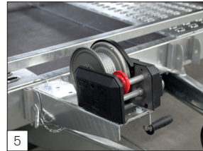
5 Serienausstattung: verstellbare Winde und Halterung HF Auto und Reling vorne herausnehmbar.
