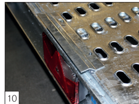
10 Serienausstattung: U-Profil mit Auffahrschiene-Blockier- Konstruktion.
