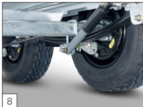
Option: Parabelfederung inklusive Stoßdämpfer.
