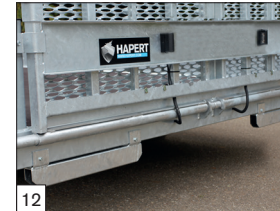
Serienausstattung: Abstützung der Ladefläche montiert.
