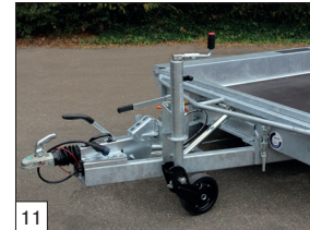
Serienausstattung: ausgestattet mit ein klappbares Automatik Stützrad. Vorderseite verstärkt.
