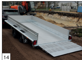
Option: Aluminium Bordwände 30 cm hoch seitlich und vorne.
