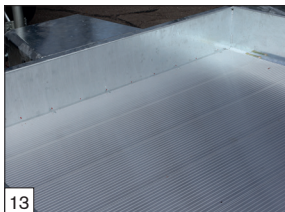
Option: Aluminium Profil-Boden montiert statt Multiplex Boden.
