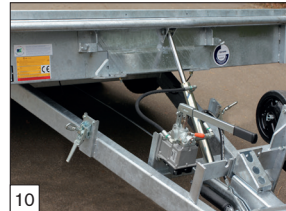
Serienausstattung: ausgestattet mit einer doppelt wirkenden Hydraulik-Pumpe.
