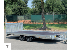
7 En série : Pneus 195/50 R13 avec jantes noires aux modèles en 450 et 505 cm de longueur avec lames de ressorts paraboliques.
