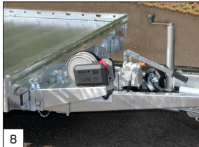
8 En série : treuil montée avec support réglable et amovible sur le devant.
