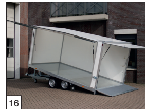
16 Option : les fourgons Indigo HT ont en série une rampe à l'arrière sur toute la largeur de 1000 mm et au dessus un hayon pivotante vers le haut.
