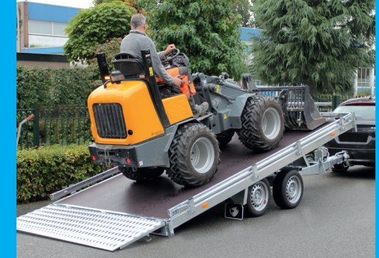
7 En série : Pneus 195/50 R13 avec jantes noires aux modèles en 450 et 505 cm de longueur avec lames de ressorts paraboliques.
