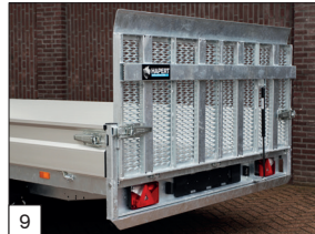
9 En série : rampe sur toute la largeur de 100 cm de hauteur avec verin à gaz et fermetures robustes.
