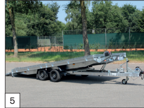
5 En série : essieux lames de ressorts paraboliques avec amortisseurs aux modèles en 450 et 505 cm de longueur (hauteur du plancher plus bas avec les essieux paraboliques!).
