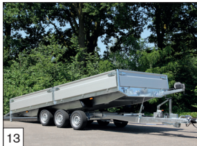
13 Option : les modèles en 455 et 505 cm de longueur sont livrables avec 3 essieux et quand ridelles en alu on a des supports centrales amovibles.
