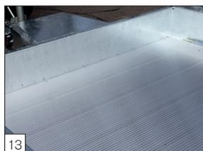
**Option :** plancher en profilés d'aluminium au lieu du plancher en multiplex.
