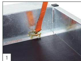
**En série :** supports d'arrimage avec une capacité de 1 000 daN intégrés dans le plancher.
