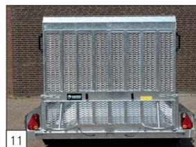
**En série :** rampe d'accès arrière continu de 1 500 mm de haut avec supports et solide suspension.
