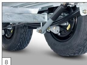
**Option :** suspension parabolique avec amortisseurs.
