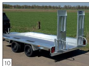
**Option :** suspension parabolique avec pneus à jantes noires 195/50 R13 ou 185/70 R 13 C et planché en profilés aluminium.
