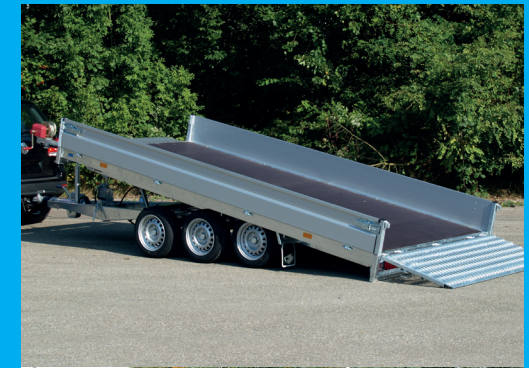
Standaard: voorzien van TÜV-goedgekeurde bindbeugels geïntegreerd in de zijrand, met een capaciteit van 1000 daN per stuk.
