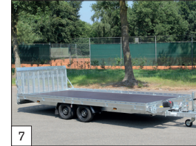
Standaard: banden 195/50 R13 C met zwarte velg bij de modellen in 450 en 505 cm. voorzien van paraboolvering.
