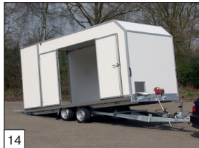
Optie: diverse gesloten opbouw mogelijkheden met bijvoorbeeld zijdeur(en), zijklep of aluminium rol-/schuifluiken.
