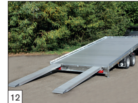
Standaard: modellen in 455 en 505 cm lengte met aluminium bordes zijn standaard met uitneembare middenrongen.
