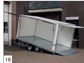
Optie: gesloten opbouw standaard met achterklep 100 cm naar beneden scharnierend, en bovenste deel naar boven scharnierend.
